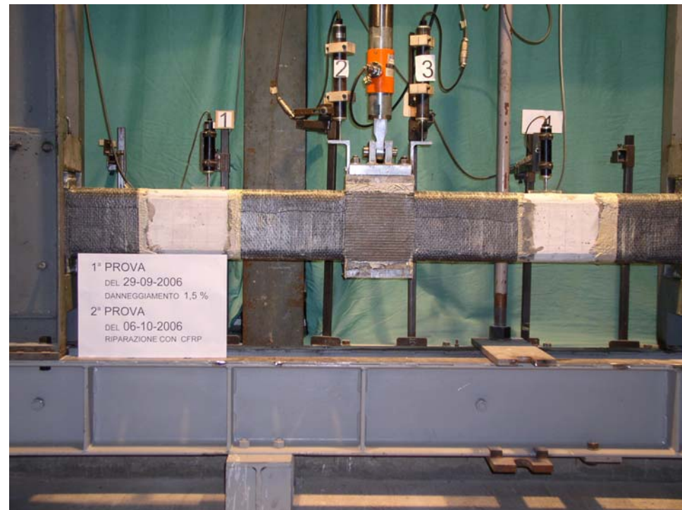
Campione FRP100-A dopo la riparazione
