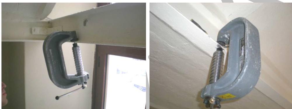
Figura 1.49: Esecuzione delle prove con il durometro sui profili in acciaio della scala interna
