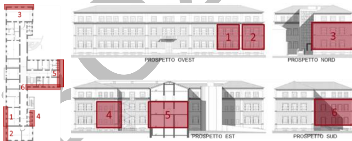
Figura 2.2 Macroelementi verificati per il meccanismo di flessione verticale.
