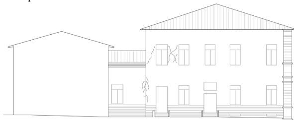
Figura 13. Rilievo del quadro fessurativo nei prospetti
