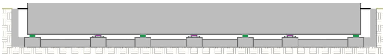
Figura 63 – Separazione tra sottostruttura e sovrastruttura.
