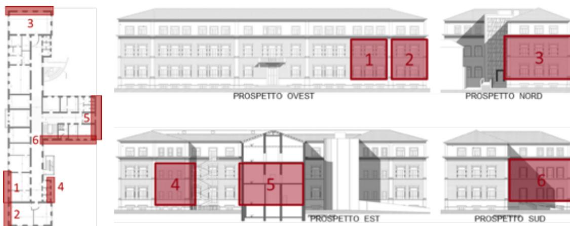
Figura 2.2 Macroelementi verificati per il meccanismo di flessione verticale.
