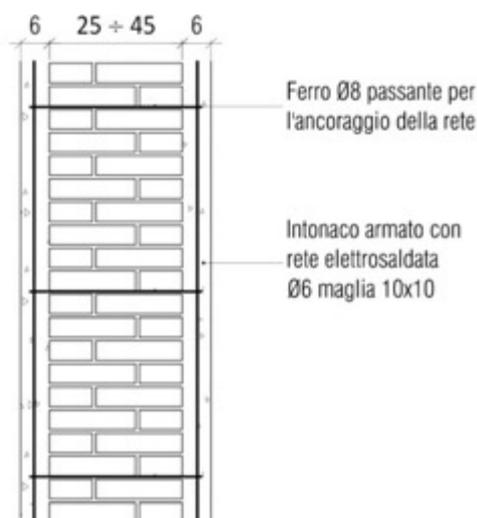
Figura 1.27: Dettaglio in sezione dell'intonaco armato per la tipologia MUR2
