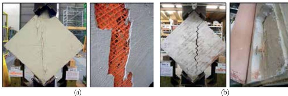
Figura 3.5. Prova di compressione diagonale su a) pannello rinforzato con TRM e b) pannello rinforzato con TRM e isolamento termico [92].
