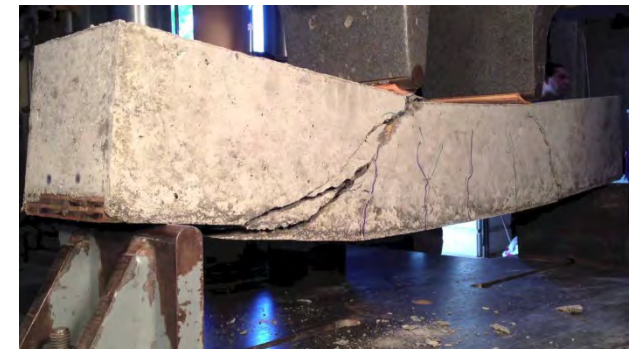
Carenza di armatura a taglio
