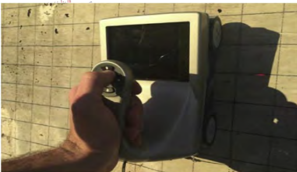
(a) StructureScan Mini HR GPR unit
