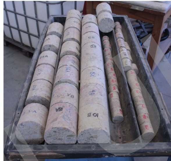
Estrazione del provino e Prove di compressione sulle carote di calcestruzzo
