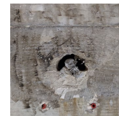
Guaina con trefoli, boiaccia parzialmente iniettata (a simulare difetto tipico)
