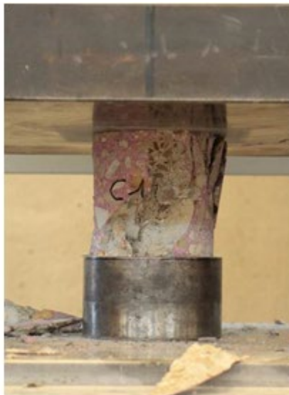
Estrazione del provino e Prove di compressione sulle carote di calcestruzzo
