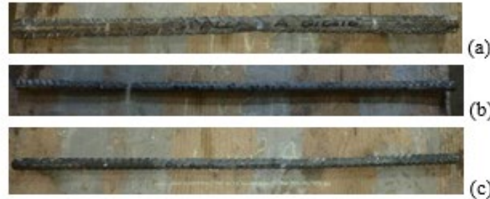
Estrazione barra d'armatura e Prove di trazione: a) Spalla A; b) Pila 5; c) Pila 9 - Viadotto autostradale
