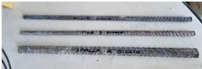
Estrazione barra d'armatura e Prove di trazione: a) Spalla A; b) Pila 5; c) Pila 9 - Viadotto autostradale
