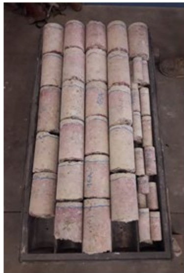
Estrazione del provino e Prove di compressione sulle carote di calcestruzzo
