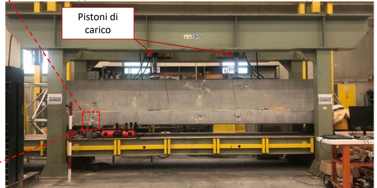
Set-up di prova: flessione a 4 punti.
