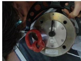
**Perni strumentati** per la misura del carico sugli stralli
