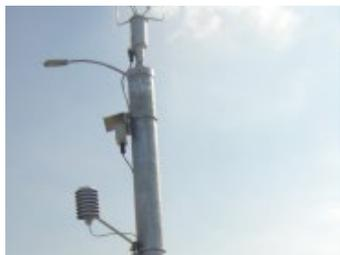
**Stazioni Meteo** distribuite lungo il ponte per fornire misurazioni delle caratteristiche del vento, delle precipitazioni, dell'intensità della radiazione solare, della temperatura e umidità
