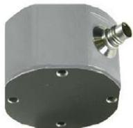
**Accelerometri** per la misura della vibrazione degli stralli indotta dal vento e la risposta dinamica della fondazione delle torri
