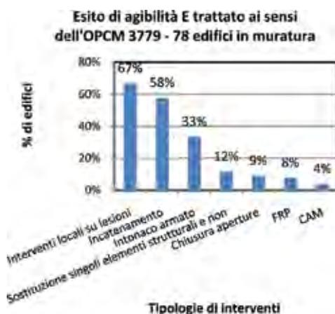
Figura 3.17. Interventi di riparazione e di rafforzamento locale negli edifici in muratura con esito E trattato ai sensi dell'O.P.C.M. 3779.
