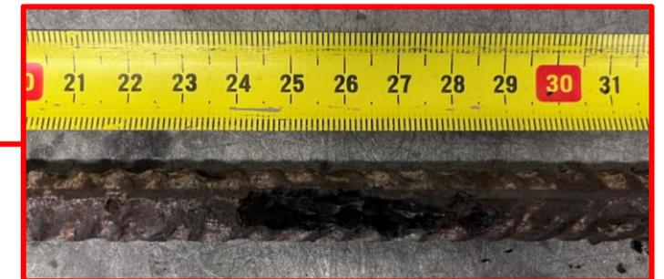
STATO DELLA BARRA DOPO 4 MESI SOTTO CORRENTE
