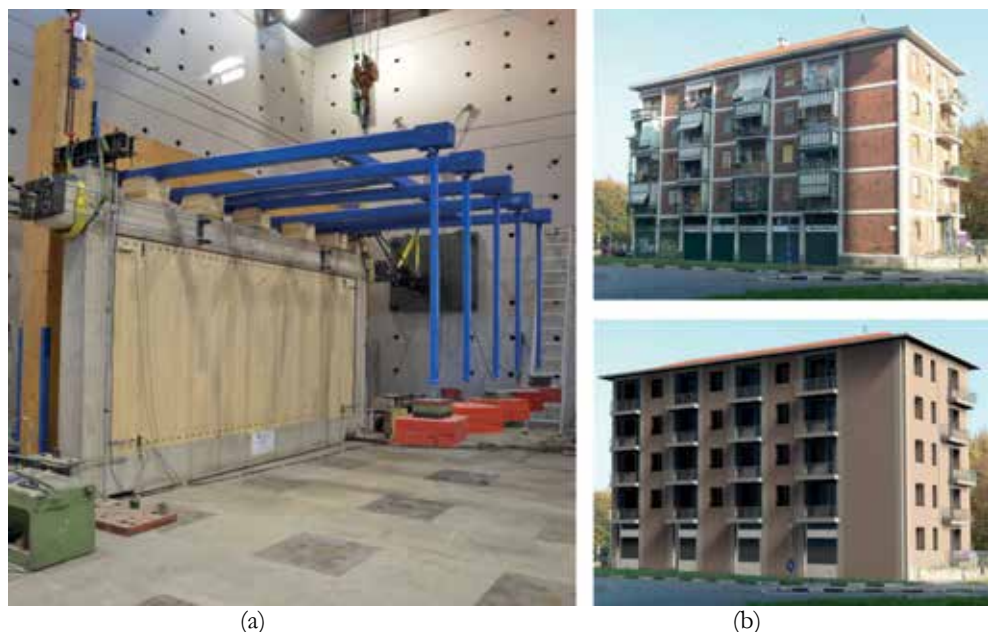
Figura 3.19. Placcaggio con pannelli CLT di edifici c.a.: test di laboratorio [166] (a) ed esempi applicativi (b).
