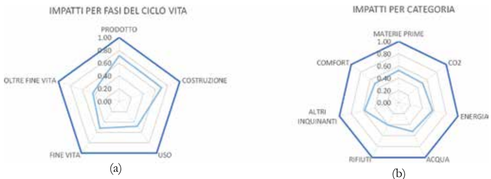
Figura 4.12. Grafici radar per la comparazione grafica delle soluzioni in termini di potenziali impatti nelle varie fasi del ciclo di vita (a) o considerando varie categorie di impatto (b) (in blu: soluzione migliore A+; nel centro: soluzione peggiore A-; in azzurro: soluzione intermedia).
