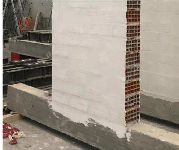
Pareti perimetrali in muratura di mattoni forati (fori disposti in orizzontale) e telaio di spina in c.a pilastri 30x30, travi 30x40
