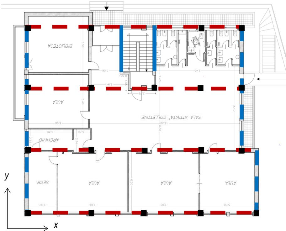
La struttura è costituita da telai resistenti a momento in c.a. (MRF) con solai misti in cemento armato e laterizi.
