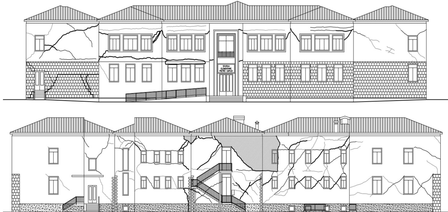
Restituzione del quadro di danno della Scuola P.Capuzi di Visso (secondo i dati raccolti da S.Cattari e D.Sivori a seguito di un sopralluogo effettuato in data 8 dicembre 2016)
