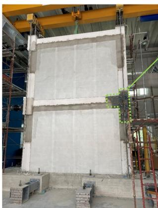
Rinforzo a taglio del pannello di nodo e della testa del pilastro (FRP)
