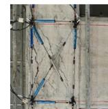
Le prove di laboratorio condotte su telai con cappotti termici di ultima generazione hanno dimostrato la capacità del cappotto termico di accomodare elevate domande di spostamento e, nel contempo, hanno evidenziato la necessità di utilizzare degli approcci di tipo "INTEGRATI" che prevedano l'utilizzo di interventi efficientamento energetico combinati con interventi di rinforzo sismico al fine di scongiurare l'innesco di eventuali crisi fragili.
