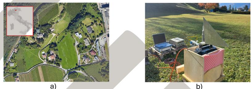
Fig. 4 – Le immagini mostrano il sito dove sono state eseguite le prove a) e il corner reflector posizionato sullo shaker b) LVDT
