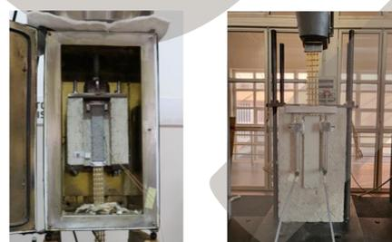
Prove di flessione su travi in cemento armato rinforzate con FRCM dopo l'esposizione a temperature elevate
