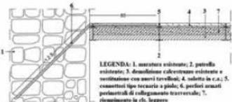
LEGENDA: 1. marmita esistente; 2. piumella esistente; 3. demolizione calcestruzzo esistente e sostituzione con nuovi tavelloni; 4. soletta in c.a.; 5. connettori tipo necessari a piano; 6. perfori armati perimetrali di collegamento trasversale; 7. riempimento in ch. leggero
