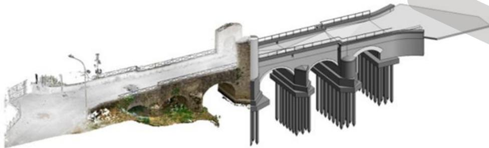
3. Modello parametrico a partire dalla procedura scan-to-BIM
