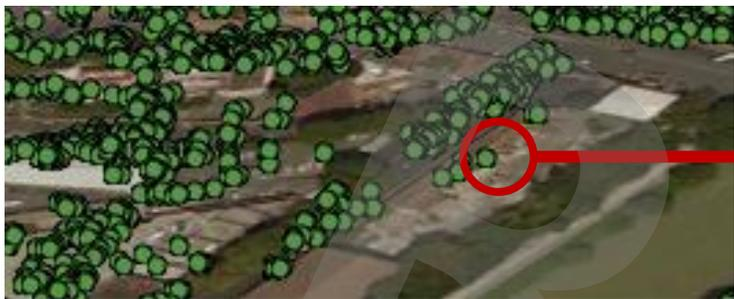
Per ciascun punto di misura viene fornita la storia temporale della componente di spostamento lungo la LOS.
