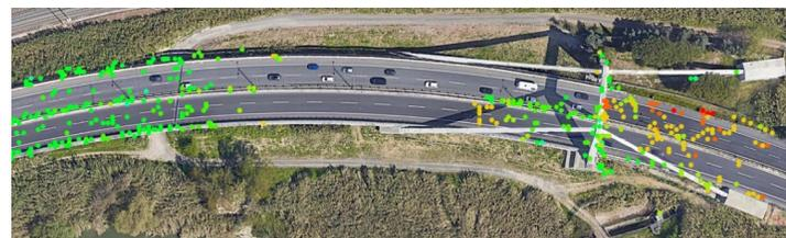
la velocità media di spostamento lungo la LOS presenta lo stesso segno sia in geometria ascendente sia discendente
