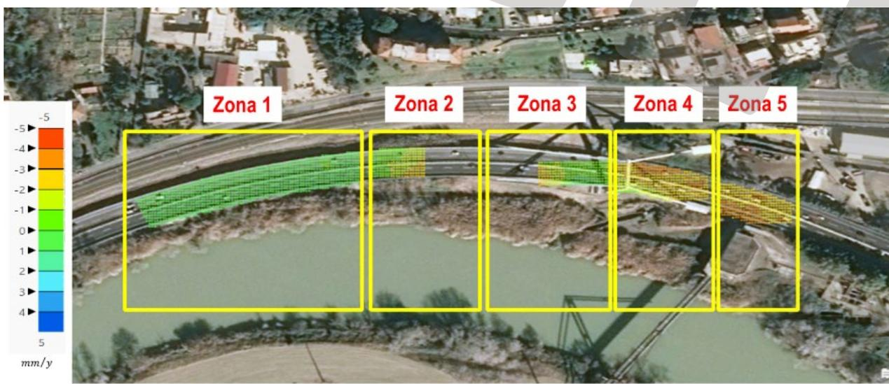
*Esecuzione di un ricampionamento spaziale distinto per ogni porzione omogenea della struttura, considerando i punti appartenenti ai singoli tratti in modo separato rispetto al resto dell'opera, poiché caratterizzati da uno stesso tipo di comportamento*
