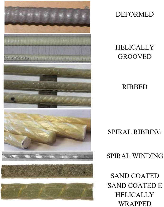
Figura 9.6: Tipologie di finitura superficiale di barre in FRP.
