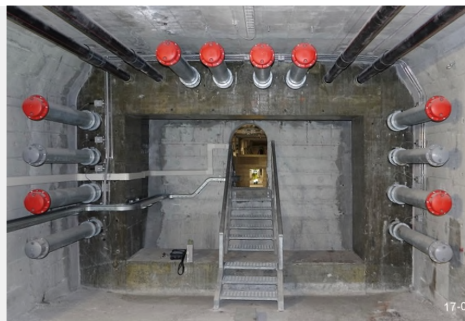
Celle di carico – cassone lato BZ in carreggiata nord
