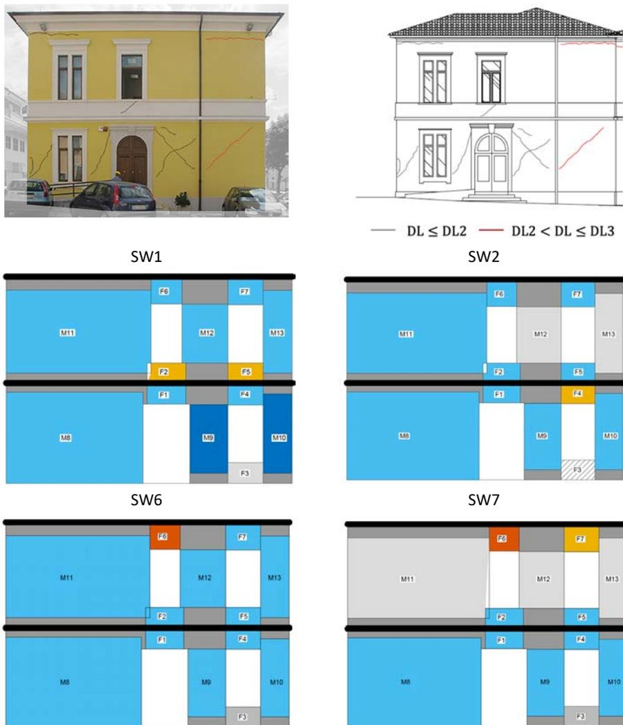
**Figura 130** – Confronto tra il quadro del danno della parete P1 in corrispondenza dello spostamento ultimo simulato dai diversi SW– caso C della struttura benchmark n°6, analisi in direzione +Y- e danno realmente occorso.
