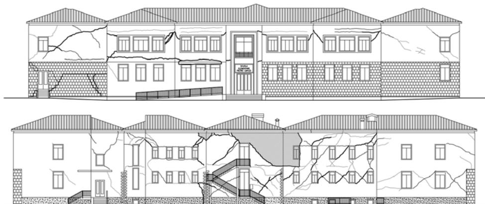
**Figura 2** – Restituzione del quadro di danno della Scuola P.Capuzi di Visso (secondo i dati raccolti da S.Cattari e D.Sivori a seguito di un sopralluogo effettuato in data 8 Dicembre 2016): le linee nere più spesse sono associate a lesioni molto gravi. La porzione evidenziata in grigio è quella in cui si è attivato un meccanismo di ribaltamento fuori piano dopo la scossa del 26 Ottobre 2016 (figura riadattata da Cattari e Magenes 2022-<https://doi.org/10.1007/s10518-021-01078-0>)
