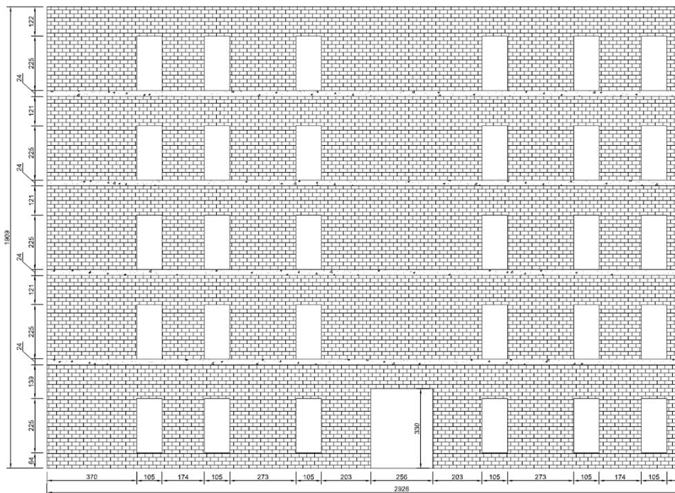
**Figura 2**– Geometria della struttura benchmark n°3 (la figura a titolo di esempio si riferisce alla variante di tipo C proposta, ossia con cordoli di piano).
